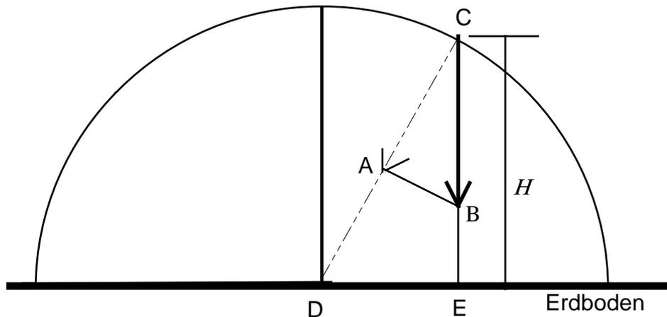
Zeige, dass die Dreiecke  $\Delta CAB$  und  $\Delta CED$  ähnlich sind. Berechne nun das Verhältnis von Normal- und Gewichtskraft, ausgedrückt durch  $H$  und  $R$ .
