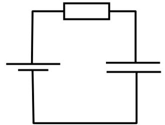
Nun werde der ohmsche Widerstand durch eine Spule ersetzt.
