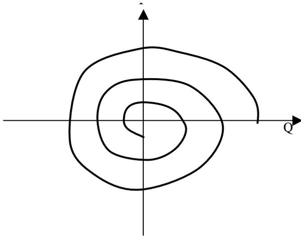
l) Wenn der Plattenabstand verringert wird, geht elektrische Feldenergie in mechanische Energie über, je nach dem wie viel Ladung sich gerade auf dem Kondensator befindet. Der Schwingkreis verliert also immer dann besonders viel Energie, wenn in ihm der Betrag der Stromstärke klein ist!
