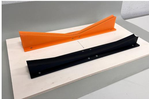
Speziell gefertigte 3D gedruckte Fahrbahnen ermöglichen die experimentelle Darstellung von harmonischen und nicht hamronischen Schwingungen im Dynamikunterricht der gymnasialen Oberstufe. Einfache Erweiterungen liefern sogar Anwendungsoptionen im Bereich Energieerhaltung der Mittelstufe.
